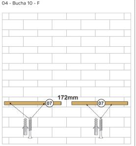
Fixar as cunhas de fixação 07 na parede com Parafuso 6x80 e Bucha 10. Deixar uma distância de 172mm entre as cunhas.
