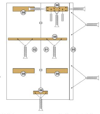
Fixar a peça 05 na peça 01 com Parafuso 3,5x22. Fixar todas as peças 08 nas peças 01 e 02 com Cavilha 6x20 e Parafuso 3,5x22. Fixar o Gabarito 09 entre as peças 01 e 02 conforme ilustração acima. Fixar as chapinhas de ferro entre as peças 01 e 02 com Parafuso 3,5x12.
