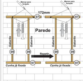
Encostar os 2 gabaritos 09 na cunha 07 já fixada na parede, colocar a outra cunha encostada na parte superior do gabarito e marcar a parede para colocar a bucha e fixar a cunha com Parafuso 6x80.
