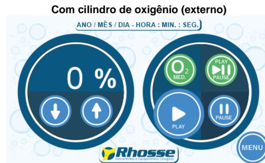
**NOTA:** Os ajustes relacionados a brilho, data, hora, percentual de intensidade de produção de ozônio e utilização de O<sub>2</sub> gerado pelo compressor de ar (interno) ou O<sub>2</sub> do cilindro de oxigênio (externo) são memorizados pelo equipamento e mantidos para próxima utilização.
